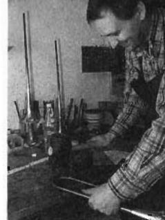
2 ベルから伸びる管体をエンドレス氏独自の角度に曲げる作業。奥に見えるのが角度を決める型紙。
