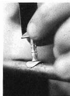
6 中に入れた金属ビスを叩きつぶし、支柱と管体との接続部品をつなぐ。
