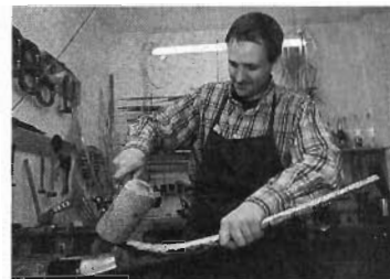
1 ベルになる部分を2種類の金槌を使い分けて伸ばし、形を整えて叩き鍛えてゆく。
