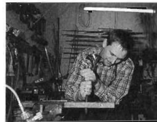
3 体重を使って押し、金槌で叩き、手作業で曲げてゆく。
